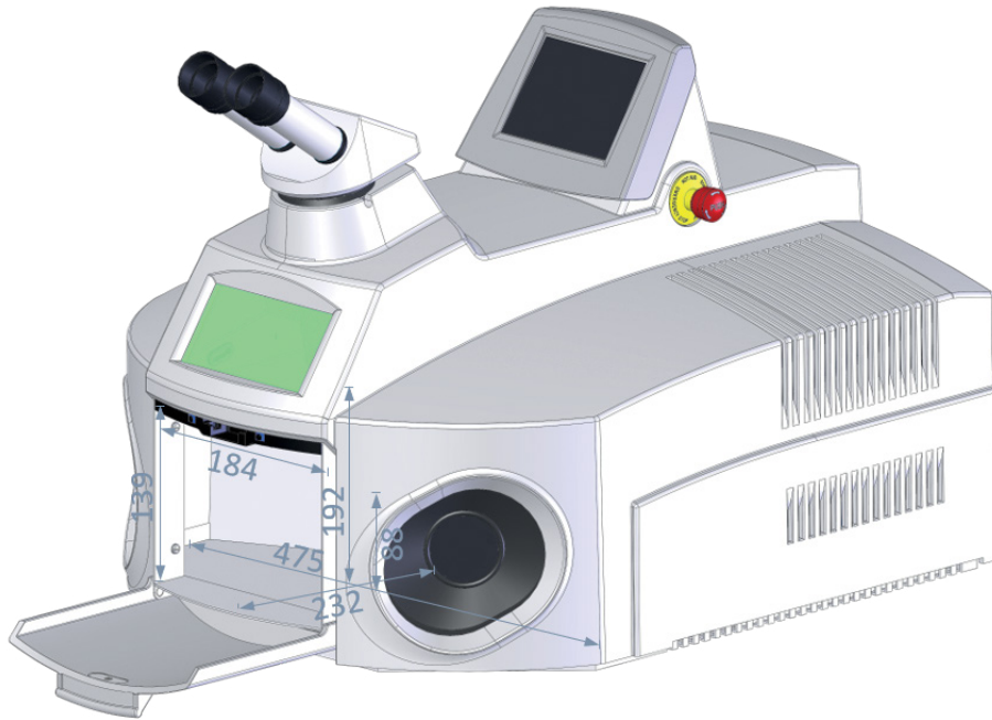
Figura 6: Dimensioni della camera di saldatura
