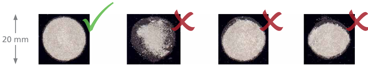
Figura 26: Impronta del punto di bruciatura laser su carta fotografica
