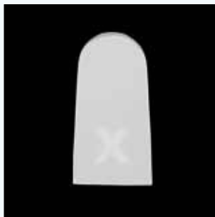
Fig. 5: provino cotto a temperatura troppo bassa
