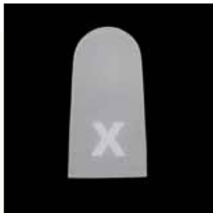
Fig. 5: provino cotto alla temperatura corretta
