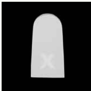
Fig. 6: provino cotto a temperatura troppo bassa
