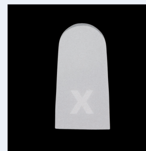
Fig. 5: provino cotto a temperatura troppo bassa
