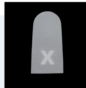
Fig. 4: provino cotto alla temperatura corretta
