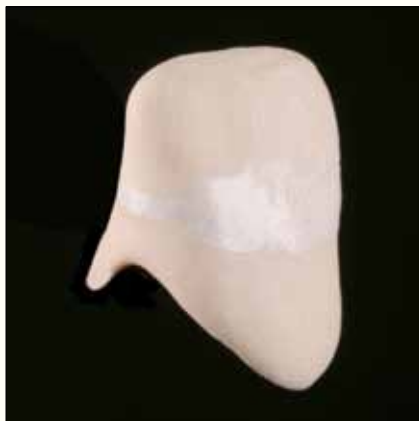
Fig. 4 : Opaque en pâte après cuisson avec inclusion d'une bandelette blanche
