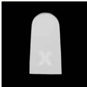
Fig. 5 : Échantillon insuffisamment cuit
