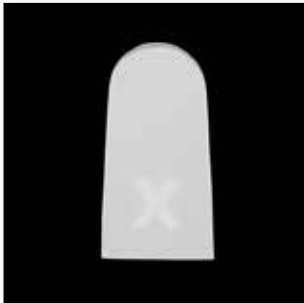
Fig. 6 : échantillon insuffisamment cuit
