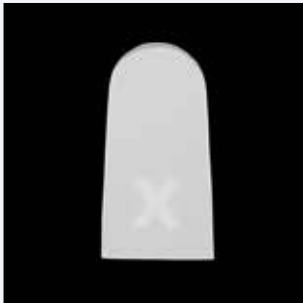
Fig. 5 : échantillon insuffisamment cuit
