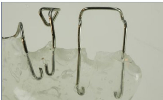
Abb. 14 Bei lichthärtenden Kunststoffen mit erhöhter Sprödigkeit können an den Austrittsstellen der Klammern Risse entstehen.
