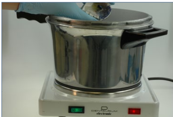
Abb. 10 Durch eine Wärmeplatte kann das Wasser im Drucktopf (Polyclav, Dentaforum) für den gesamten Zeitraum der Polymerisation konstant gehalten werden.
