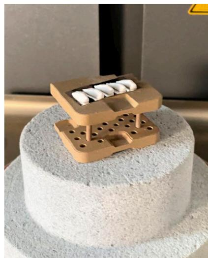
► ... sur feuille de platine prête à cuire. Cette surélévation permet aux cuissons-tests d'occuper dans le four une position similaire à celle qu'occupent habituellement nos couronnes.
