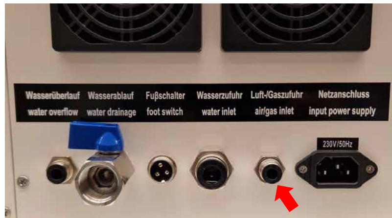
Imagen 13 Conexión de gas
