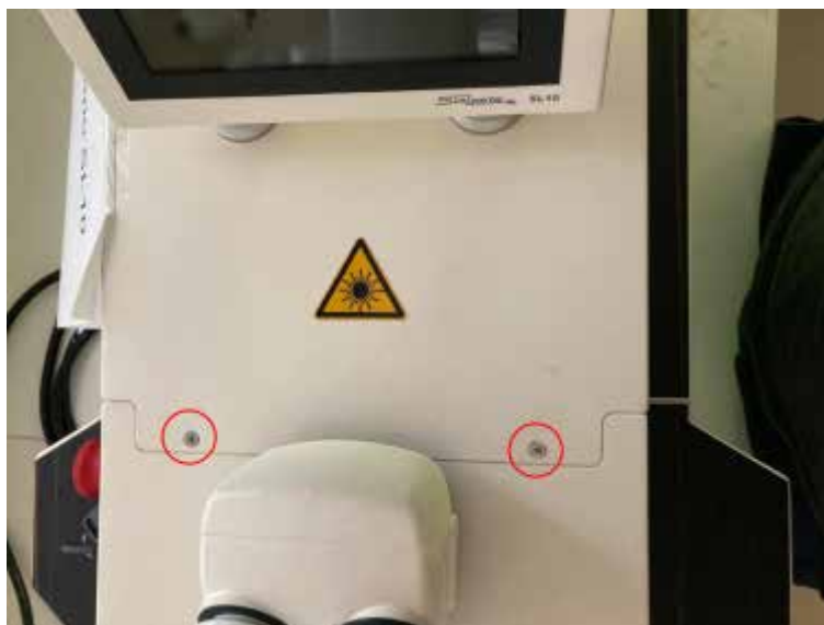
Imagen 21 Tornillos de la carcasa
