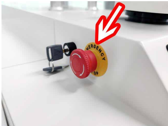
Imagen 1 Parada de emergencia
