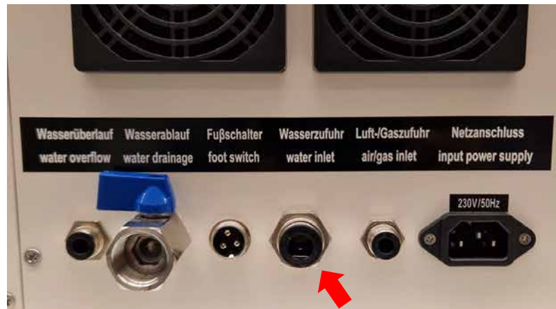
Imagen 11 Entrada de agua
