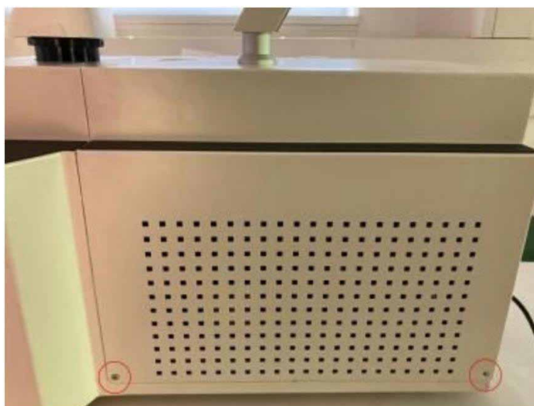
Imagen 22 Tornillos de la carcasa
