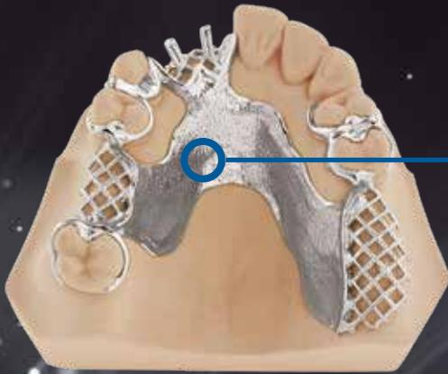
Espesor del panel base 0,6 mm - 0,8 mm,
