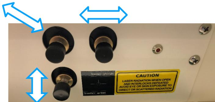
Lösen Sie nun die Festellschrauben der 3 Drehregler im oberen Bereich der Arbeitskammer.
