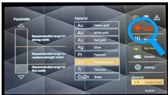
Der Laser verfügt über einen Sicherheits-Strahlverschluss (Safety Shutter), dieser muss bei jedem Neustart einmal geöffnet werden. Drücken Sie dazu auf das Icon im Display. Der Laser ist nur bei grün geschaltetem Safety Shutter betriebsbereit.
