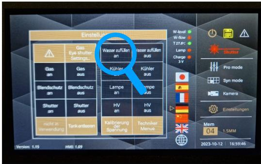
Um die Wasserzufuhr zu starten, drücken Sie den „Wasser auffüllen an“ Button. Der Vorgang stoppt automatisch, wenn das Gerät ausreichend mit destilliertem Wasser befüllt ist. Das Statuslämpchen W-level im Display sollte nun auf grün sein, wenn
