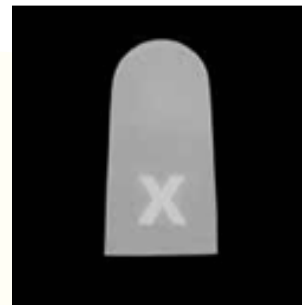
Fig. 4: prueba de cochura correcta
