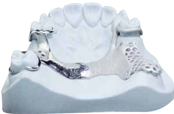
Modellgusspassung nach Wärmebehandlung.
