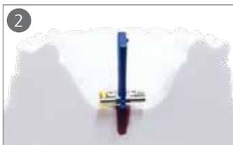
**Die Funktion der Schraube wird durch den sie umgebenden Kunststoff gewährleistet. Dieser sollte dem Schraubenkörper und dem Gewinde komplett anliegen. Die Bremsbohrungen sollten komplett durch Kunststoff umschlossen werden.**
